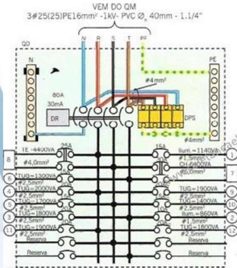
Esquema multifilar do QD.
