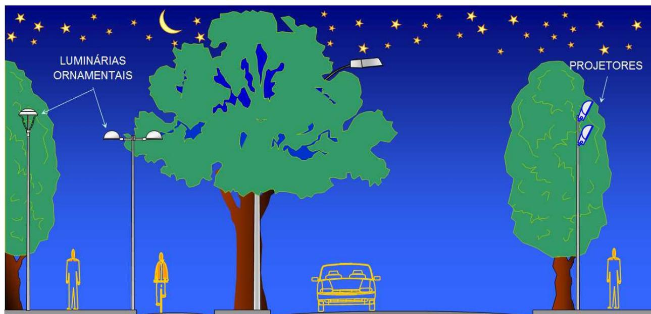
Figura 29 - Propostas para projetos específicos de iluminação pública para passeios em áreas com intensa arborização.
