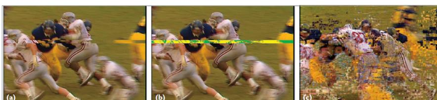
FIGURA 3.2 – PRINCIPAIS ERROS DE CODIFICAÇÃO E DECODIFICAÇÃO DE VIDEO
