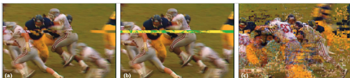
Figura 2 - Artefatos de vídeo. (a) erro de fatia (b) erro de fatia com partes perdidas realçadas (c) blocking (GREENGRASS; EVANS; BEGEN, 2009)
