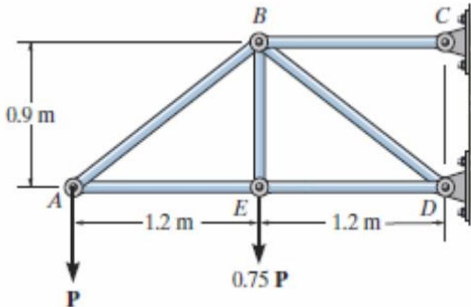
**Problema 4.** (1.59) Cada uma das barras da treliça tem área transversal de  $780 \text{ mm}^2$ . Se a tensão normal média máxima em qualquer barra não pode ultrapassar 140 Mpa, determine o valor máximo P das cargas que podem ser aplicadas à treliça
