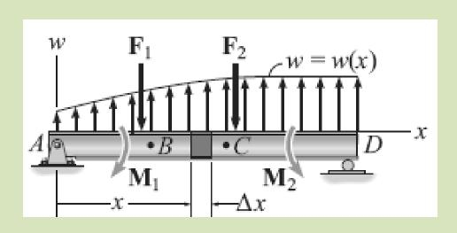
Um diagrama de corpo livre para um pequeno segmento da viga  $\Delta x$  escolhido em um ponto x ao longo da viga, que não está sujeito a uma força concentrada.
