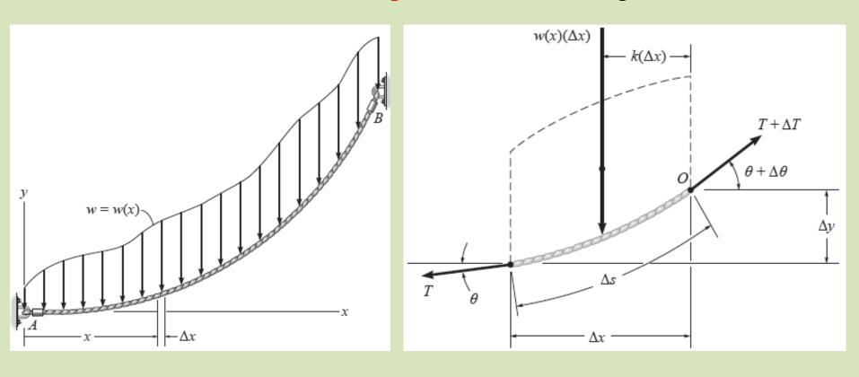
O diagrama de corpo livre de um segmento pequeno do cabo tendo um comprimento  $\Delta s$   $\acute{e}$  mostrado na figura acima
