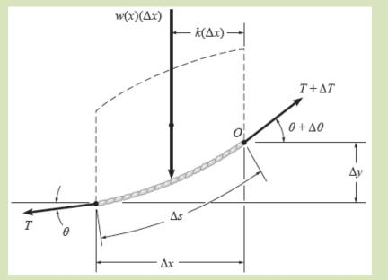
Dividindo cada uma dessas equações por  $\Delta x$  e tomando o limite quando  $\Delta x \rightarrow 0$ , e, portanto,  $\Delta y \rightarrow 0 \ \Delta \theta \rightarrow 0 \ \Delta T \rightarrow 0$  obtemos:
