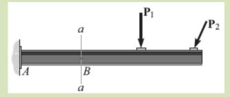
Ao seccionar a viga em a-a, as cargas internas que atuam em B serão expostas e se tornarão externas no diagrama de corpo livre de cada segmento.
