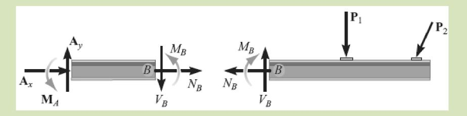
Aqui as direções foram escolhidas aleatoriamente. A verdadeira direção deve sair das condições de equilíbrio  $\Sigma F_x$ =0  $\Sigma F_y$ =0 e  $\Sigma M_B$ =0
