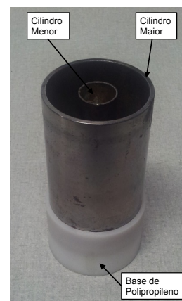
Figura 4 - Capacitor de cilindros coaxiais desenvolvido para as medidas experimentais
