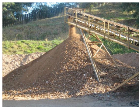
Figura 5 - Material de bica corrida utilizada em pavimentação
