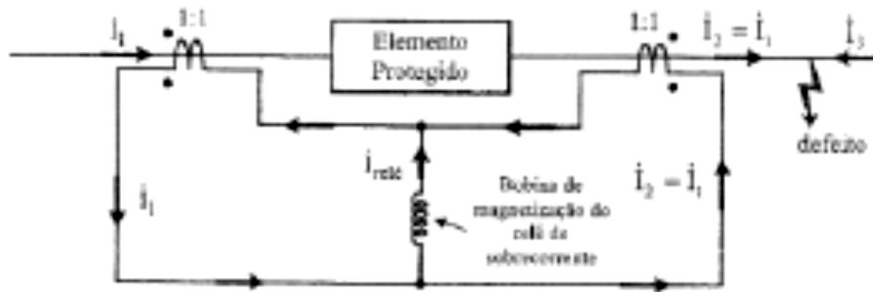
DEFEITO EXTERNO A ZONA PROTEGIDA
