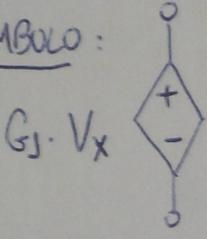
onde  $G_1$  é um parâmetro (no conhecido) chamado de ganho e medido em  $[V/V]$  ou adimensional e  $V_x$  é a tensão sobre algum elemento do circuito, exceto a tensão sobre a própria fonte.
