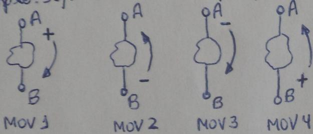
Explicando: em MOV 1 tem-se uma carga positiva se movimentando do terminal A para o terminal B; em MOV 2 há uma carga negativa se movimentando do terminal B para o terminal A; em MOV 3 uma carga negativa se desloca do terminal A para o terminal B; em MOV 4 uma carga positiva se desloca do terminal B para o terminal A.
