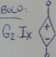
onde  $G_2$  é um parâmetro (no conhecido) chamado de ganho e medido em  $[V/A = \Omega]$  e  $I_x$  é a corrente sobre algum elemento do circuito, exceto a corrente sobre a própria fonte.
