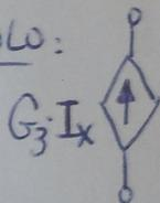
onde  $G_3$  é um parâmetro (no conhecido) chamado de ganho e medido em  $[A/A]$  e  $I_x$  é a corrente sobre algum elemento do circuito, exceto a corrente sobre a própria fonte.
