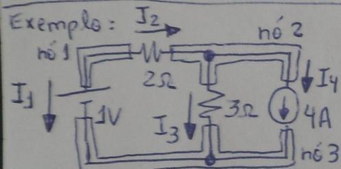
No circuito do exemplo, há 4 elementos de circuito. Para cada um desses 4 elementos, foi definida uma corrente sobre ele com sentido arbitrário. Há 3 nós nesse circuito, que foram chamados de nó 1, nó 2 e nó 3. O nó 1 conecta 2 terminais; o nó 2 conecta 3 terminais; o nó 3 conecta 3 terminais.
