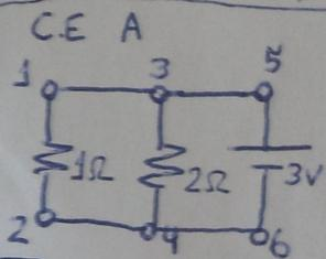
**EXPLICAÇÃO:** NO ESQUEMÁTICO DO C.E. A, OS TERMINAIS 1 (do  $EL_1$ ), 3 (do  $EL_2$ ) e 5 (do  $EL_3$ ) ESTÃO CONECTADOS ENTRE SI. DE MODO ANÁLOGO, OS TERMINAIS 2 (do  $EL_1$ ), 4 (do  $EL_2$ ) e 6 (do  $EL_3$ ) TAMBÉM ESTÃO CONECTADOS ENTRE SI. AS RETAS LIGANDO TERMINAIS DE ELEMENTOS DIFERENTES APENAS INDICAM A CONEXÃO ENTRE OS TERMINAIS E TÊM O PROPÓSITO DE TORNAR A VISUALIZAÇÃO MAIS CLARA.
