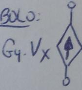
onde  $G_4$  é um parâmetro (no conhecido) chamado de ganho e medido em  $[A/V = 1/\Omega]$  e  $V_x$  é a tensão sobre algum elemento do circuito, exceto a tensão sobre a própria fonte.
