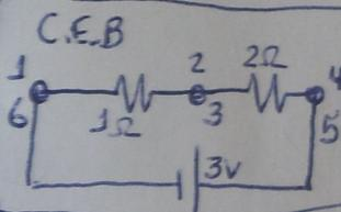
**EXPLICAÇÃO:** NO ESQUEMÁTICO DO C.E. B OS TERMINAIS 1 (do  $EL_1$ ) e 6 (do  $EL_3$ ) estão conectados entre si; os terminais 2 (do  $EL_1$ ) e 3 (do  $EL_2$ ) estão conectados entre si; os terminais 4 (do  $EL_2$ ) e 5 (do  $EL_3$ ) estão conectados entre si.
