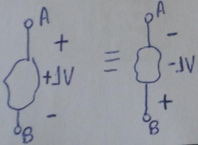
Explicando: se a tensão (ou d.d.p) sobre um determinado elemento tem intensidade de +1V com polaridade sendo + em A e - em B, isso é equivalente a trocar o sinal da intensidade (passando para -1V) desde que também seja trocada a polaridade (passando o + para o terminal B e o - para o terminal A).
