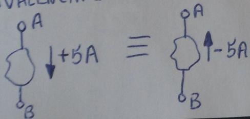
Explicando: se a corrente sobre um determinado elemento tem intensidade de +5A e sentido de A para B, isso é equivalente a trocar o sinal da intensidade (passando para -5A) desde que também seja trocado o sentido da seta do movimento (passando de B para A).
