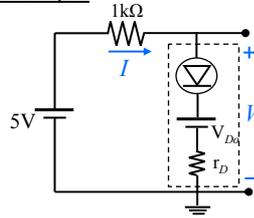
Diodo conduz  $\Rightarrow V = V_{D0} + r_D \cdot I$
