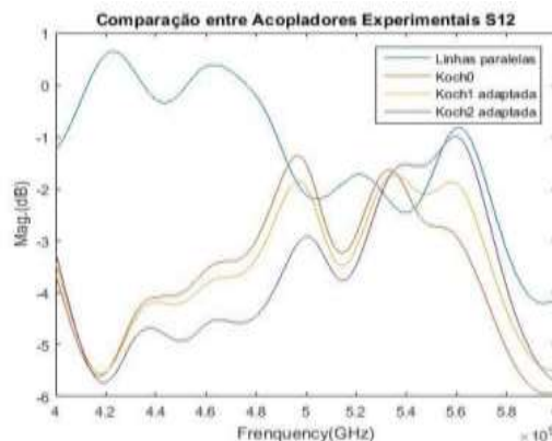
Fig. 10 Acopladores de Koch adaptada da ordem 0, 1 e 2, em função da operação frequência, variando de 4 GHz a 6 GHz.
