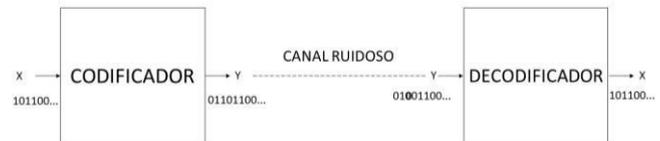
Fig. 1. Funcionamento típico de um código corretor de erros [1].
