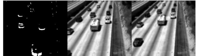
Fig 3. Resultados da subtração de dois frames com a aplicação de filtros de baixa e média complexidade.
