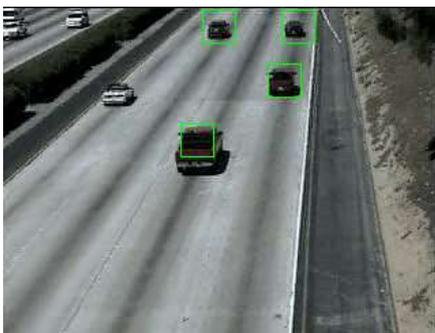
Fig 2. Resultados obtidos em software utilizando o algoritmo Haar Cascades.
