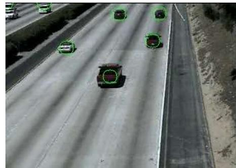
Fig 4. Resultados obtidos em software utilizando o algoritmo Blob Detection.
